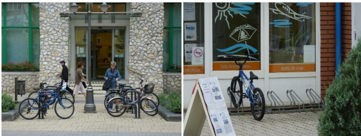
62. ábra: P támaszok a posta előtt, illetve hagyományos támaszok az autóbusz-állomásonál (utóbbinál csak az első kerék lakatosolható, a váz nem)
