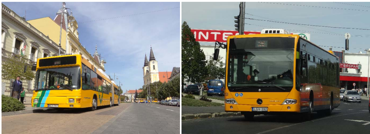
42. ábra: Biogáz üzemű helyijáratú autóbusz / Korszerű, alacsonypadlós Mercedes autóbusz, az útírányt jelző homlokfali utastájékoztató eszköz nélkül
